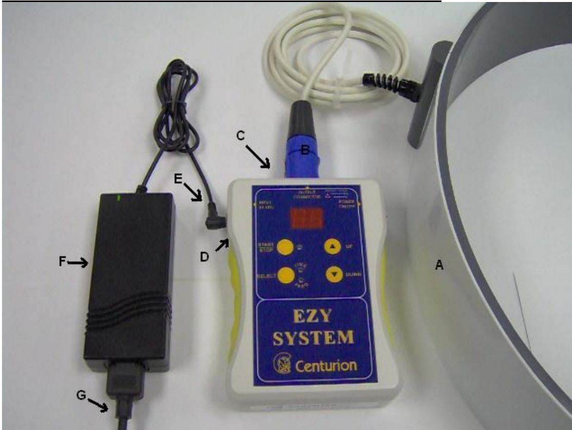
**Figure #1: La boîte de commande (D) , l'adaptateur de courant (F), et l'applicateur Cylindre (A) du Système-EZY**
