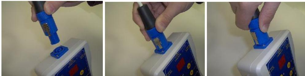
**Figure #2: Branchement du connecteur de sortie bleu de l'applicateur dans la boîte de commande**
