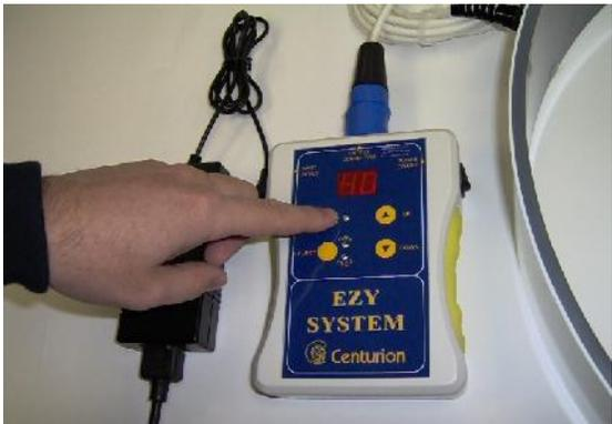
Figure #28: initiez le traitement en appuyant sur le bouton START/STOP. MARCHE/ARRET. Le temps du traitement défilera en rouge dans l'écran du haut et le voyant vert à coté du bouton START/STOP MARCHE/ARRET clignotera.
